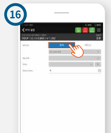
환경설정 ▶ RTK 설정 선택 후 장비 모드 ▶ 로버 선택
